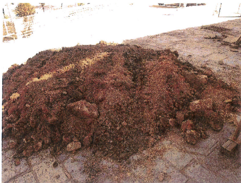
Σχήμα Χ.15β: Ερευνητικό φρέαρ Φ2. Φαίνεται το κιτρινόχρωμο μαργαϊκό υλικό που προέκυψε κατά την εκσκαφή.
