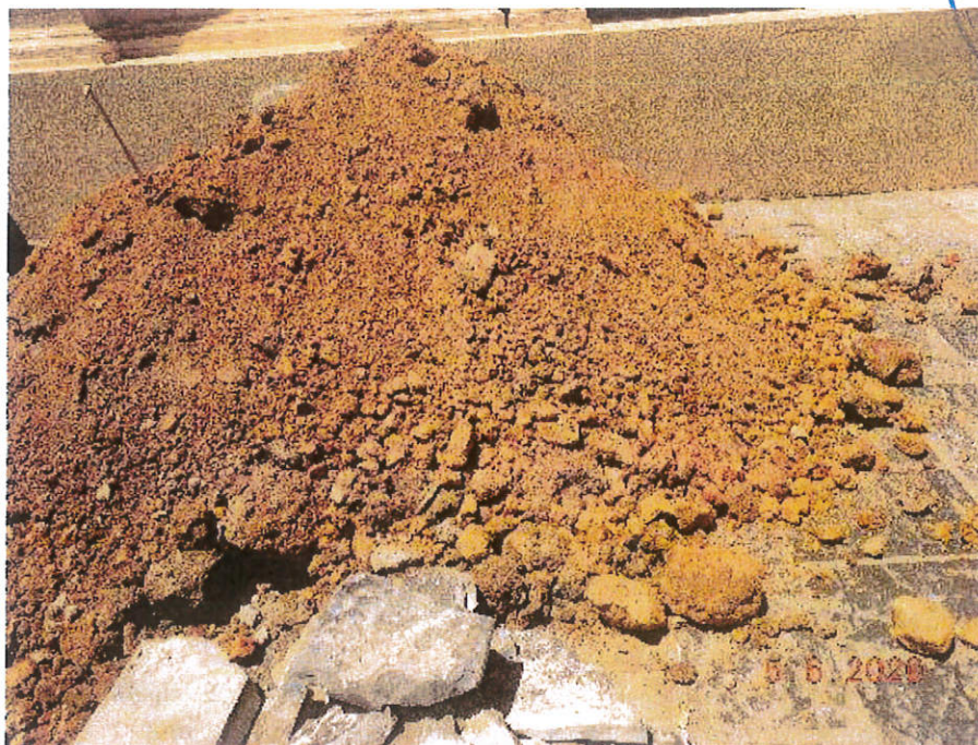
Σχήμα Χ.146: Ερευνητικό φρέαρ Φ1. Φαίνεται το κιτρινόχρωμο μαργαϊκό υλικό που προέκυψε κατά την εκσκαφή.
