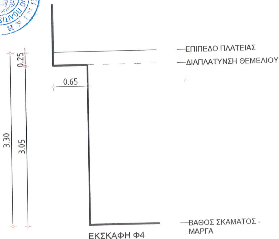
Σχήμα Χ.17β: Ερευνητικό φρέαρ Φ4. Τομή του φρέατος με σημειωμένη την στάθμη της μάργας και των υπερκείμενων ανθρωπογενών αποθέσεων. Το δάπεδο του εσωτερικού του ναού βρίσκεται περί τα 0.60μ υψηλότερα από το επίπεδο της πλατείας.
